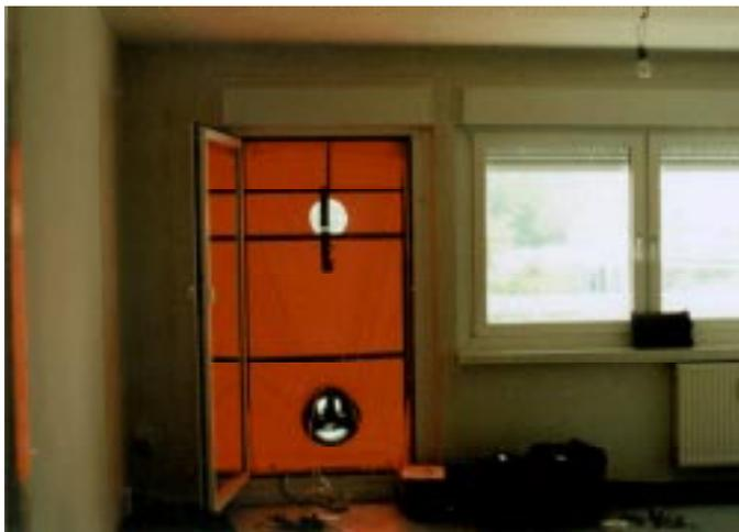
Abbildung 1: Einbau einer Blower-Door in eine Balkontür
